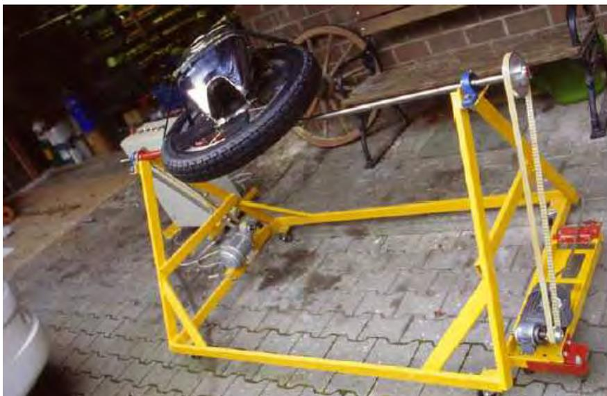
Gleitschleifmaschine mit Steuerteil für PKW-Tanks oder 2 – 3 Motorradtanks.
